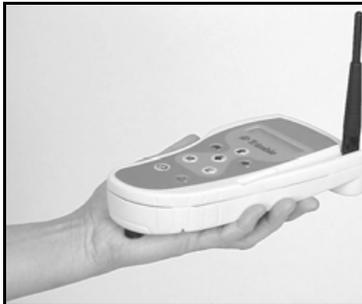
Si conecta el radiocontrol remoto a una mira, y el mismo está orientado verticalmente, la antena debe apuntar hacia arriba desde la parte superior del radiocontrol remoto.
